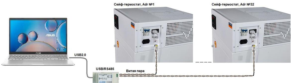
Рис. 8. Подключение интерфейса сейфов-термостатов к ПК
